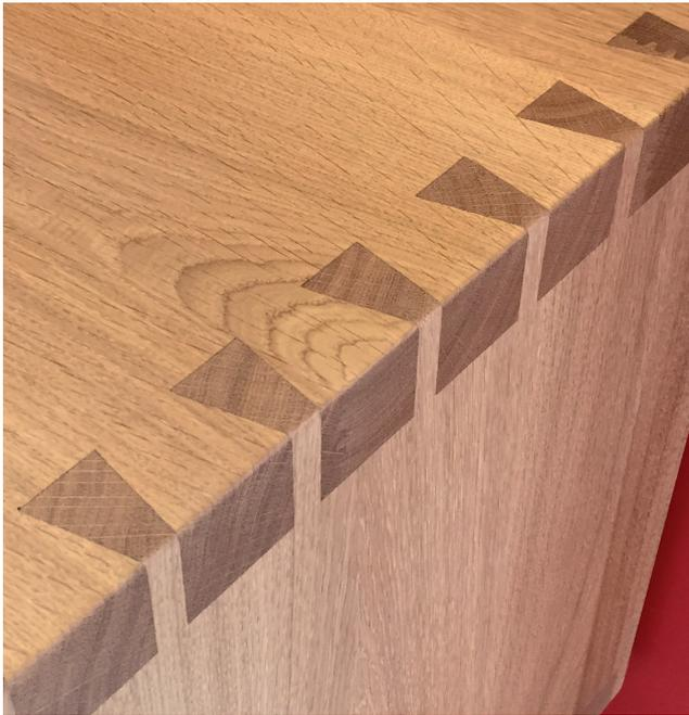
Die Verbindungselemente sind gerade und keilförmige Zapfen, die man Zinken bzw. Schwalben nennt.
