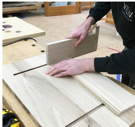
Die Korpusseiten erhalten Federn an den Längskanten. Hier sollte das Einpassen der Federn zuerst erfolgen, da bei einer schlechten Passung ggf. eine neue Seite angefertigt werden muss. Alle nachfolgenden Arbeitsschritte müssten dann ebenfalls wiederholt werden.
